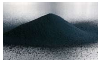
Ruß mit hohem Feinanteil nach Förderung mit zu hoher Geschwindigkeit.
